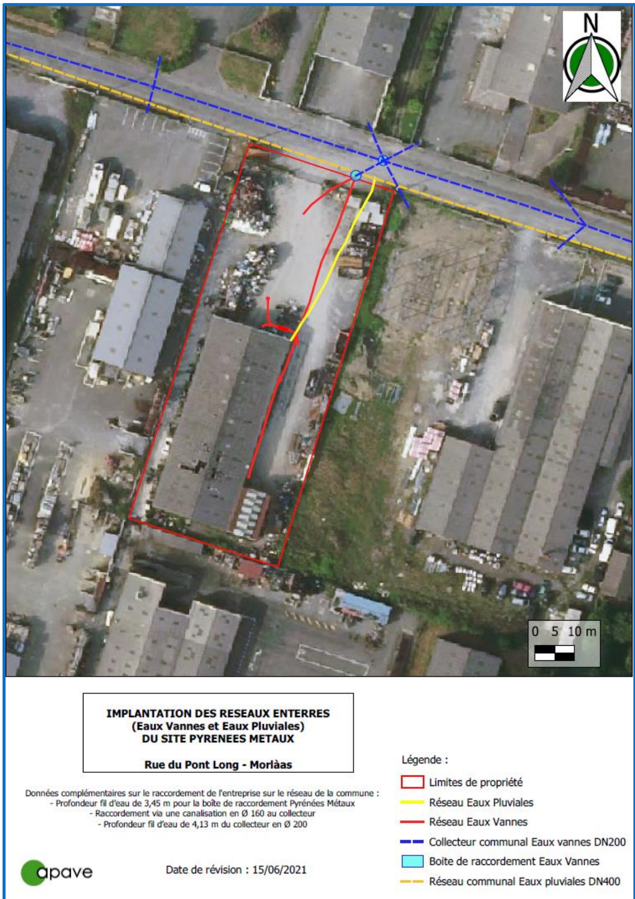
Illustration 6 : Implantation des réseaux enterrés – Source APAVE
